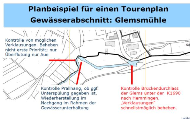
Abbildung 5: Ausschnitt aus einem sogenannten Tourenplan. Rot dargestellt sind besondere Gefahrenlagen für Personen oder Sachschäden (Foto: Angelika Lugibihl 2020)
