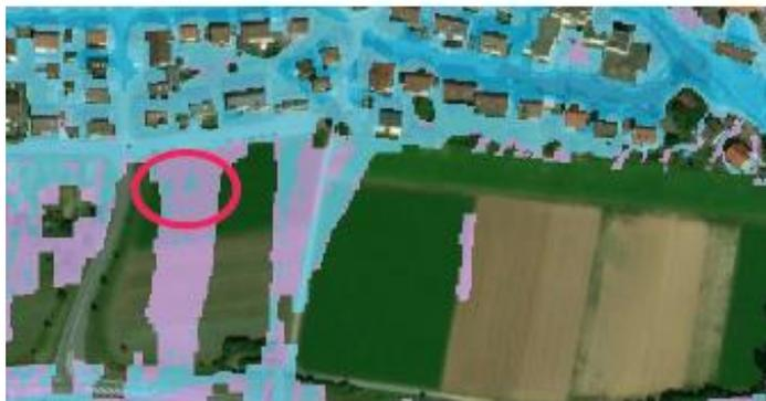
Die Starkregengefahrenkarte zeigt bei einem Regenereignis von 120 mm eine Betroffenheit an der Nordfassade, deutliche Wassermengen fließen von Süden über das Grundstück. Eine Gefährdung ist in diesem Fall nicht zu unterschätzen.
