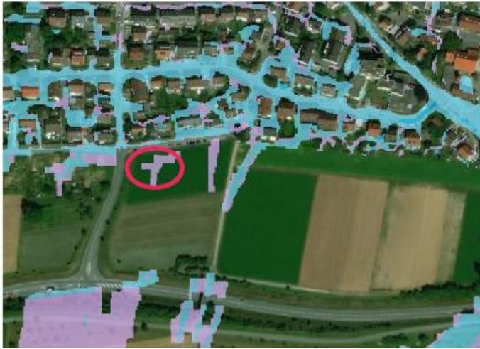
Die Starkregengefahrenkarte zeigt bei einem Regenereignis von 60 mm nur eine geringe Betroffenheit an der Nordfassade, geringe Wassermengen fließen von Süden über das Grundstück. Eine Gefährdung ist in diesem Fall gering.
