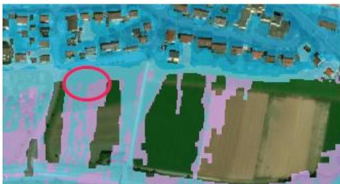
Die Starkregengefahrenkarte zeigt bei einem Regenereignis von 240 mm eine starke Betroffenheit mit deutlichen Wasserhöhen und erhöhter Fließgeschwindigkeit an der Nordfassade. Wassermengen fließen von Süden über das Grundstück. Eine deutliche Gefährdung ist in diesem
